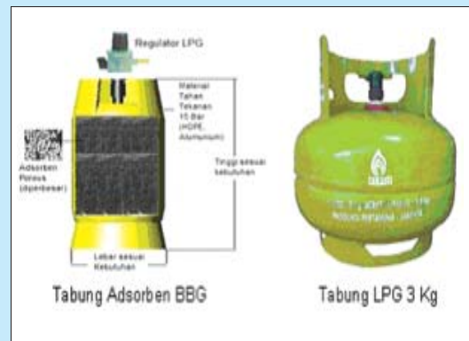
Gambar 5 Contoh Modul Adsorben BBG Sektor Rumah Tangga Komplemen LPG 3 kg
