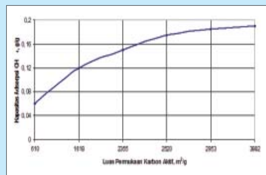
Gambar 3 Hubungan Kapasitas Penyimpanan CH 4 Dengan Luas Permukaan Karbon Aktif. 9
