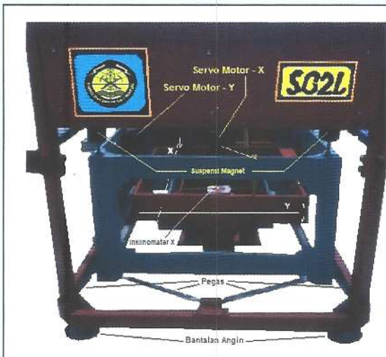
Gambar 2 Perangkat keras sistem giroskop gravitimeter laut hasil perokayasaan.
