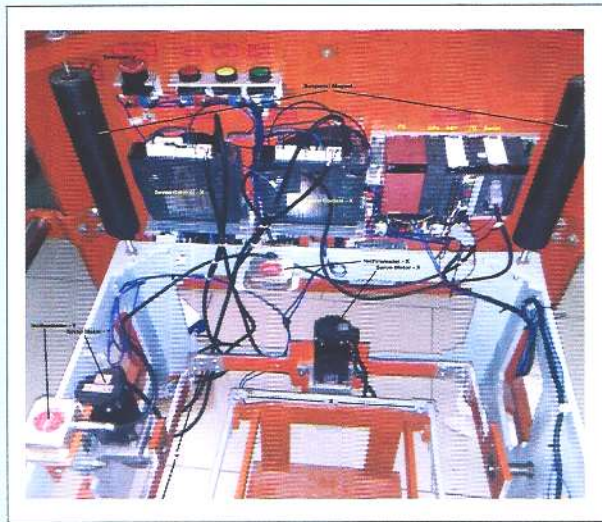
Gambar 4 Sistem kontrol gerak otomatis giroskop gravitymeter laut mengacu pada sensor inklinasi.
