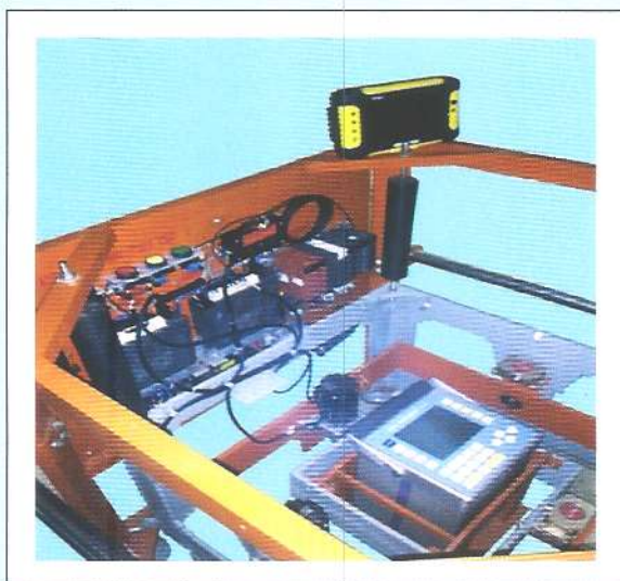
Gambar 12 Penempatan alat Gravitimeter darat pada giroskop untuk pengukuran gayaberat di laut.
